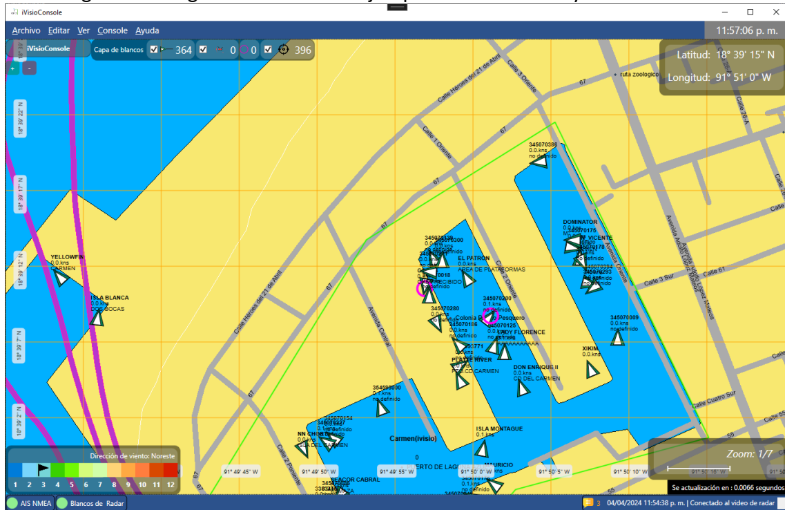
Ilustración 1 Alarma de colisión CPA y TCPA en carta náutica
